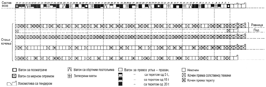
Слика 5. Састав и кочење композиције А 2
