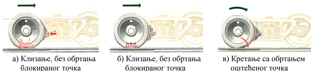
Слика 31. Формирање „равног места“ на точку дужине „А“
