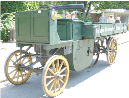
Слика 3а. Дрвени точкови обложени металним оплатама
