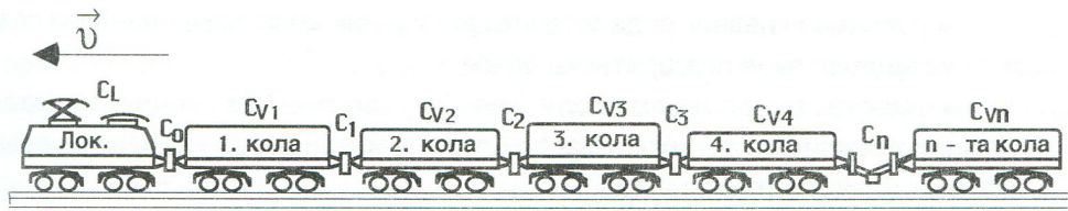
Слика 5. Воз као редни осцилаторни систем
