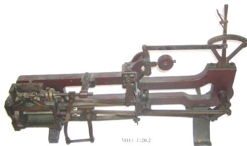
МНТ Т: 20.2 Westinghousov брзодејствујући расподелник
