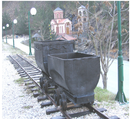
Слика 3б. Метална кола за превоз руде
