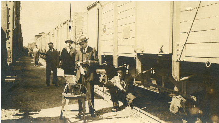
Слика 2. Испитивање кочнице пробног воза у радионици Загреб, инжењер Божић је означен стрелицом (фото: Железнички музеј Београд)
