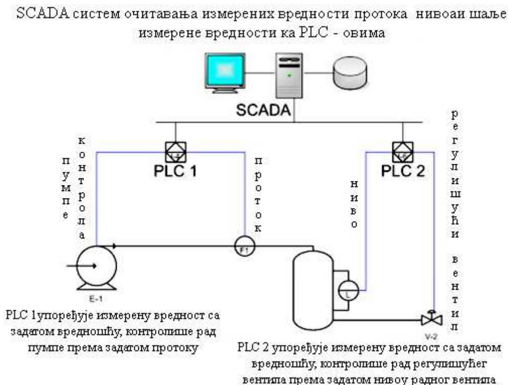
Слика 1. Једноставан SCADA систем
