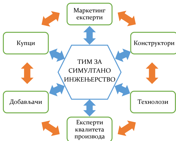
Слика 2.2 – Концептуални модел симултаног инжењерства за глобалну производњу [2]
