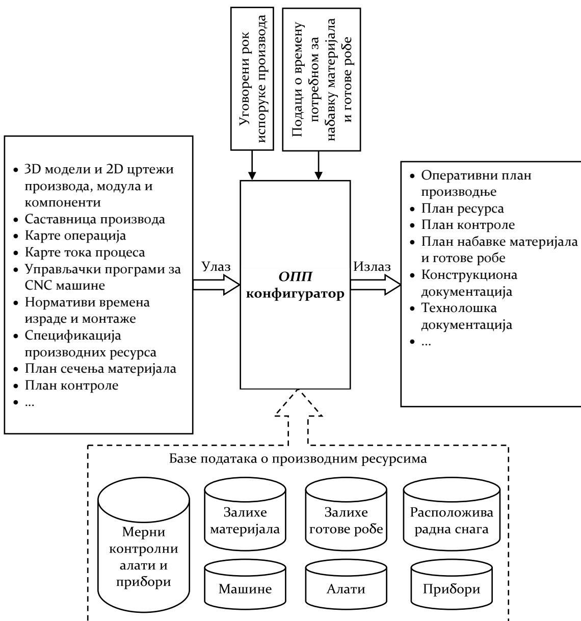
Слика 3.8 – Структура ОПП конфигуратора
