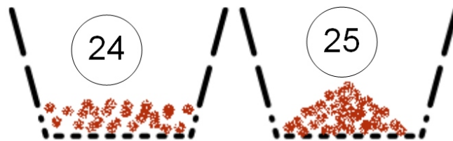
Слика 4. Принцип сагоревања на номиналној и редукованој снази.
