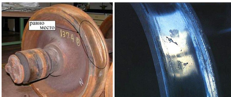
Слика 4.26. Оштећења површине котрљања точка [53], (Railway Technical Web Pages)
