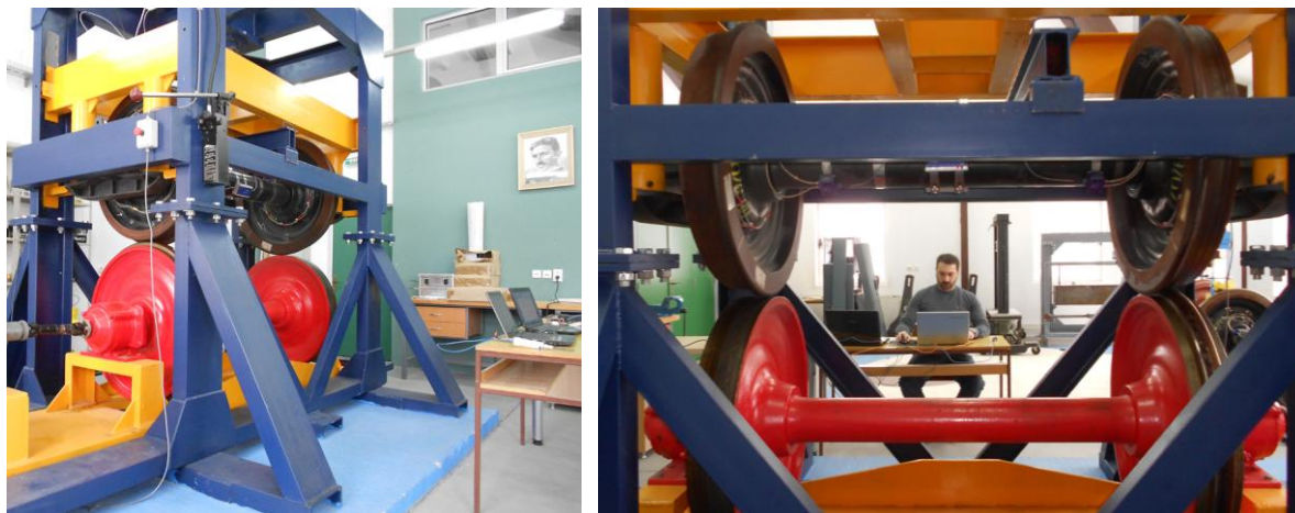
Слика 7.65. Детаљи са експерименталних испитивања са циљем тестирања и верификације развијене методе и алгорита инверзне идентификације
