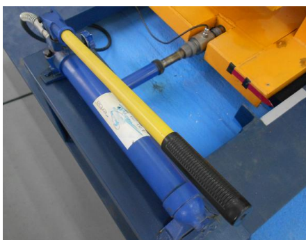
Слика 7.11. Системи за задавање и регистровање бочне силе Y_p на пробници
