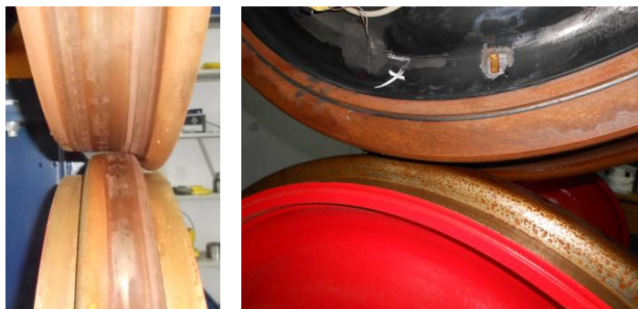
Слика 7.6. Имитација контакта точак-шина на пробници (лева страна)
