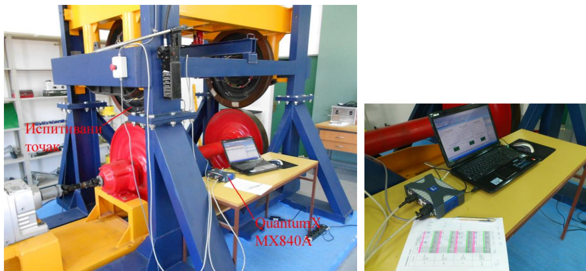
Слика 6.59. Детаљи са експерименталних испитивања точка у циљу верификације нумеричког модела
