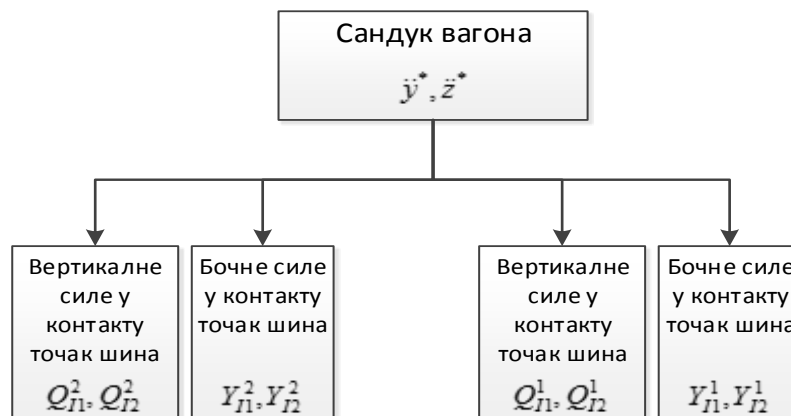
Слика 4-7. Графички приказ валидационе хијерархије модела железничког возила без обртних постоља
