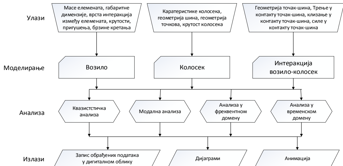
Слика 5-1. Процес моделирања и симулације динамичког понашања железничких возила
