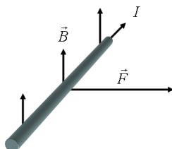
Prema prethodnoj jednačini, jedinica za indukciju magnetskog polja je  $[B] = [F]/[I][l] = \text{N/Am}$ . Ova jedinica u SI ima posebno ime i naziva se "Tesla", po pronalazaču Nikoli Tesli, a označava se sa "T".
