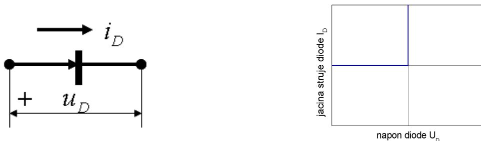
Grafikon pokazuje da je jačina struje jednaka nuli kada je napon na diodi negativan (kada je dioda *inverzno polarisana*), a da je napon na diodi jednak nuli kada struja protiče u propusnom smeru (kada je dioda *direktno polarisana*).
