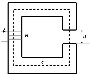
gde je sa  $R_{mag}$  označena magnetska otpornost magnetika, a sa  $R_{vazduh}$  magnetska otpornost procepa, koje se mogu odrediti prema sledećim formulama (uzimajući da je relativna magnetska propustljivost vazduha bliska jedinici):
