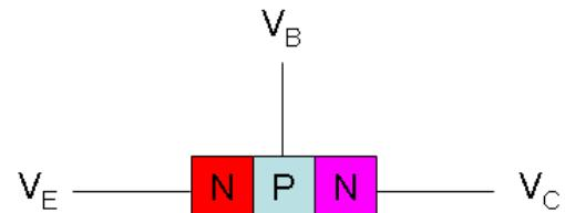
1. Kada su oba spoja polarisana direktno (dakle kada je  $V_B - V_E > V_T$  i  $V_B - V_C > V_T$ ), kroz tranzistor protiče struja velike jačine, a tranzistor se nalazi u *režimu zasićenja*. U ovakvom režimu trazistor je analogan otvorenom ventilu, i ovaj režim se primenjuje kada se trazistor koristi kao prekidač, predstavljajući prekidač u zatvorenom stanju.
