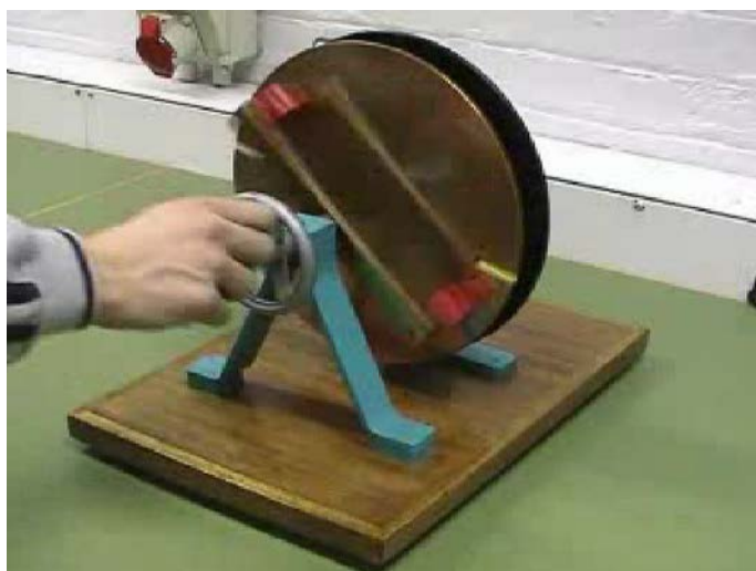
Сл. 30 Макета помоћу које се уочава принципо развијања момента код асинхроне електричне машине http://www.empr.ftn.kg.ac.rs/5%20AM/am01/AM%20demonstracija.swf
