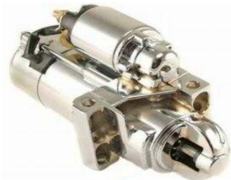
Сл. 26 Анласер (ел.покретач) 1,7 kW, 12 V
