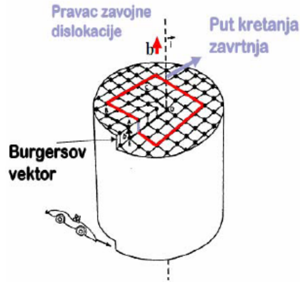
Слика 15б) Бургесов вектор завојне дислокације је паралелан са дислокационом линијом
