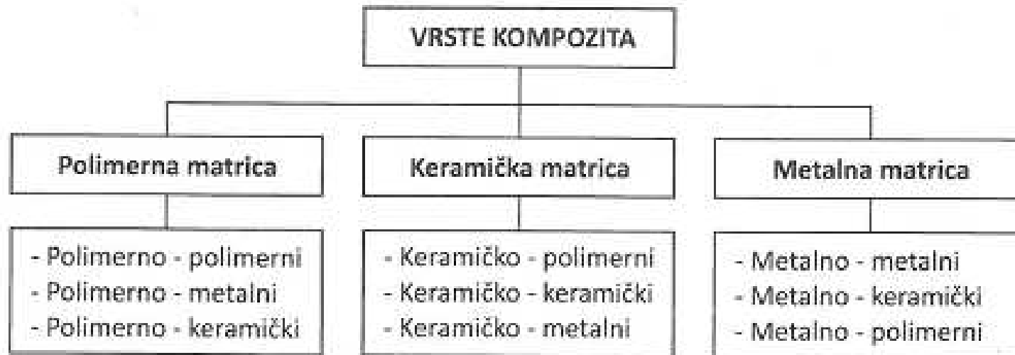
Podela kompozita na osnovu vrste matrice i ojacavaca
