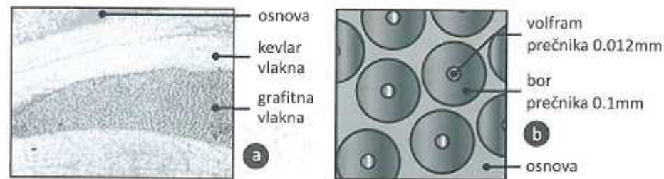
Slika 12.9. Presek: a) teniskog reketa sa grafitnim i aramidnim vlaknima; b) kompozitnog materijala ojačanog bornim vlaknima.
